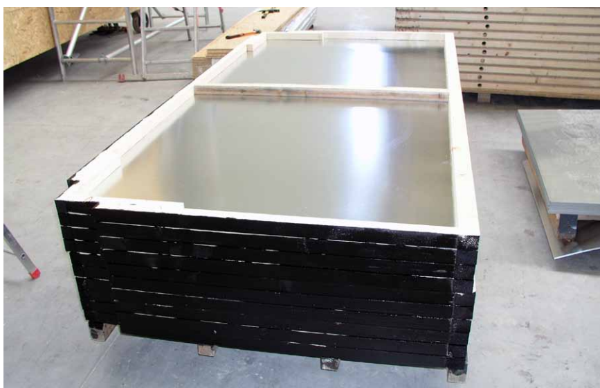
Významnou část produkce směřující na export tvoří stavební díly s různými druhy opláštění pro kontejnerové buňky
